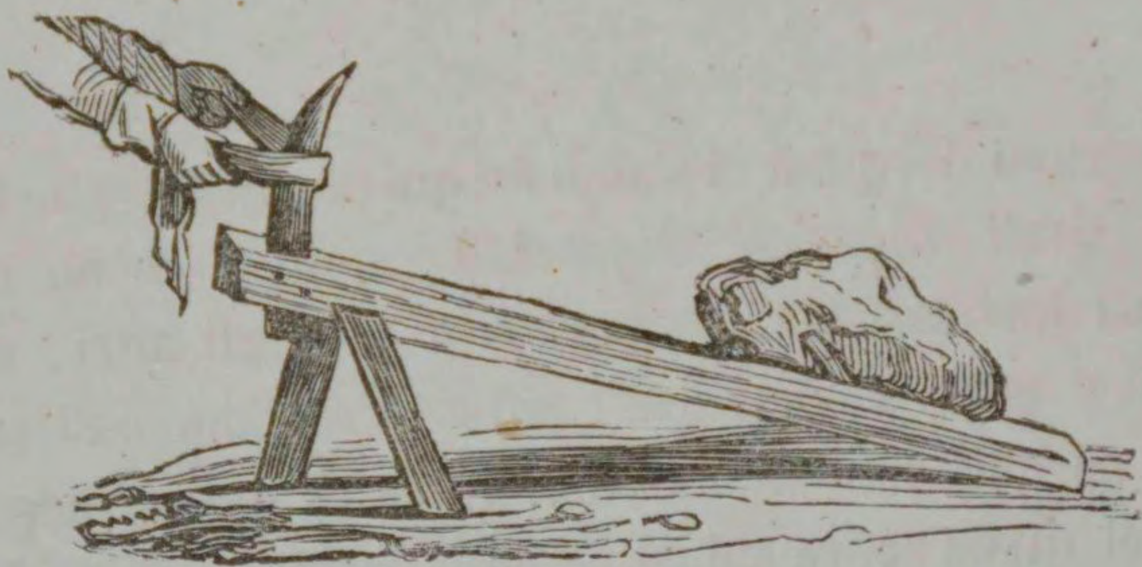
Fig. 2. — Istrumento per stracciare i cenci lani.
